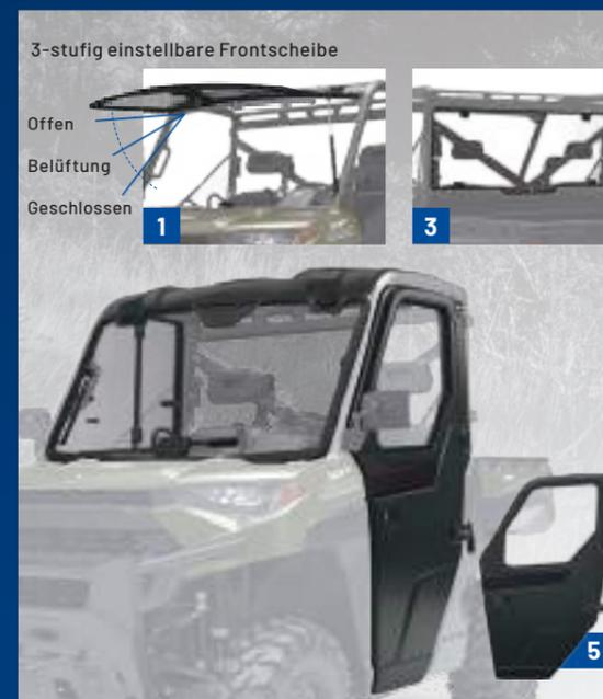
**FULL CAB** KABINEN-KIT „FULL CAB“, BESTEHEND AUS GLAS-WINDSCHUTZSCHEIBE, WISCHER, POLY-DACH, POLY-HECKSCHEIBE UND POLY-TÜREN „CLEAR VIEW“.
